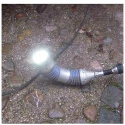
schoben werden kann. Ähnliche Systeme gibt es auch als "Schere", "Stäbchen", usw. Der grundsätzliche Vorteil dieser relativ leicht handelbaren System liegt darin, dass i.d.R. ohne Einsatz von gesondertem Spülfahrzeug und Kamerawagen mit Satellitenkamera schnell und kostengünstig fundierte Erkenntnisse und Daten über Bestand und Zustand dieser Grundstücks-Entwässerungsleitungen gewonnen werden können.
